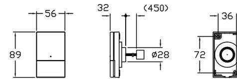
Blow Bath SX II、Air Blow II、水中照明III控制器
